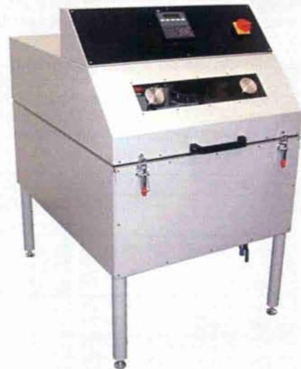
Spurbildungsgerät SBG-LW-2x320x260 (DBGM) zur Durchführung des Spurbildungsversuchs im Luft- oder Wasserbad gemäß TP A-StB und EN 12697-22
